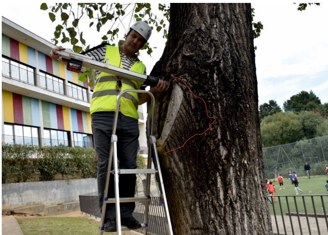
Figura 9 – Medição com resistógrafo e indicação da provável área de degenerescência do xilema.
