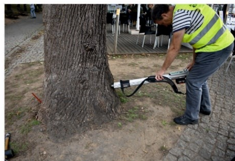
Figura 2 – Medição com o resistógrafo na árvore 1 (Parque da Mourisca).
