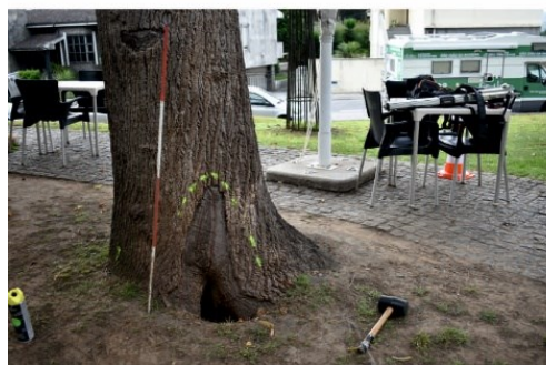
Figura 2 – Medição com o resistógrafo na árvore 1 (Parque da Mourisca).
